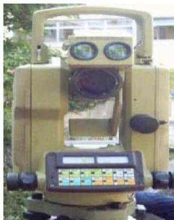
**Gambar 2.29 Instrumen Gelombang Inframerah**
