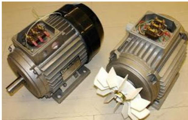
**Gambar 7.7** motor induksi AC
