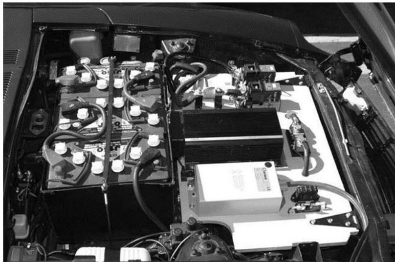
**Gambar 10.14** Baterai Operasi Z terpasang pada tempatnya.
