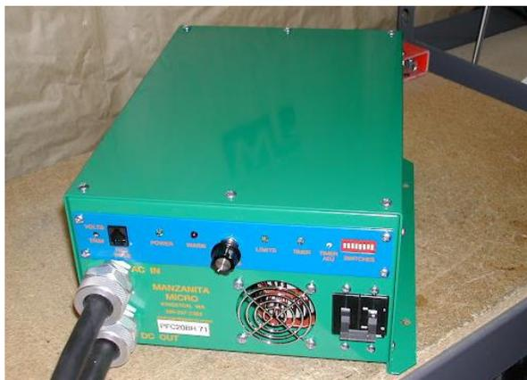
**Gambar 9.4** Manzita Micro PFC-20, pengisi daya baterai yang sangat serbaguna.
